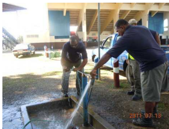
飲料水場での水圧テストと残留塩素確認
